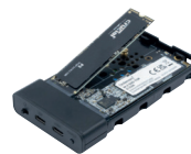
Duplicateur autonome mobile 2p SSD M.2. NVMe/SATA ventilé 924620
